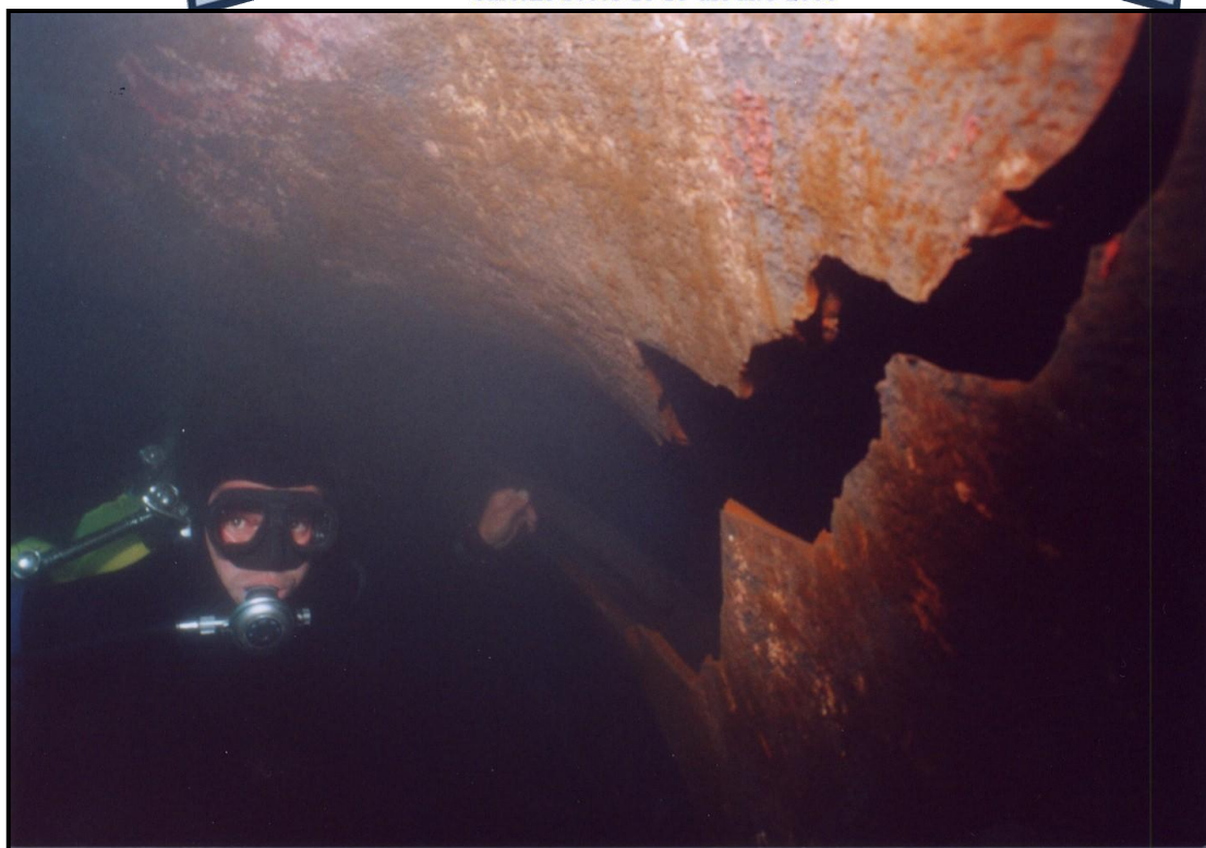
Danni subiti dallo scafo dell'Eurobulker in occasione dell'incidente
