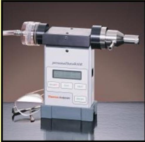
Rilevatore ottico pDR-1200 (Personal Data RAM) per la misura in tempo reale della concentrazione in massa del PM2.5 alla frequenza di 1 Hz con aspirazione e selezione dimensionale utilizzando una pompa AQUARIA ed un ciclone (2.5  $\mu\text{m}$  cut-off a 4l/m).
