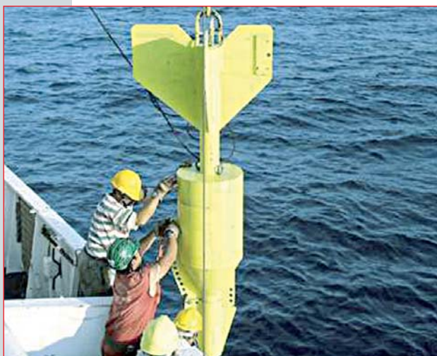
Fasi operative di un carotaggio effettuato sulla N/O Urania durante una campagna IGM-CNR di Bologna
